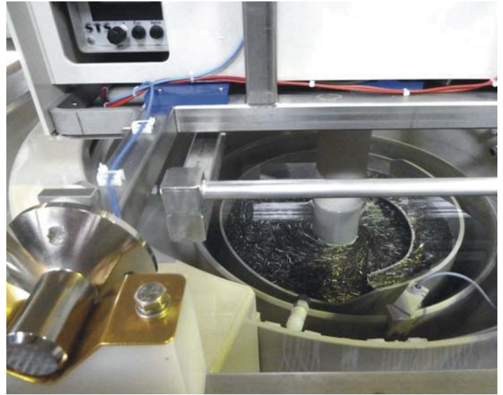
Détail d'une cuve de traitement avec panier en rotation-vibration.
