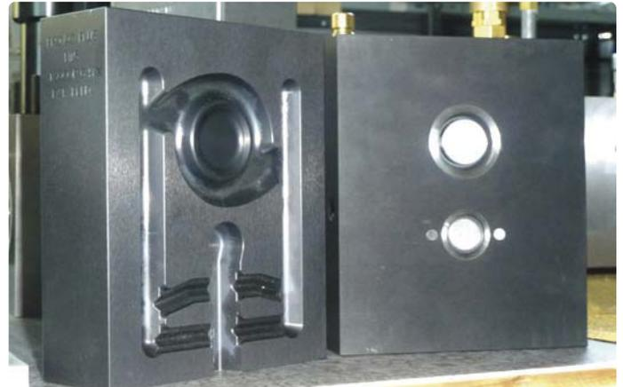
Plaque de valve à vide ProVac Typhoon.
