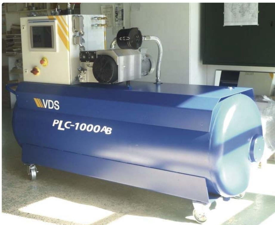
Système ProVac PLC pour presse d'injection métallique, comportant réservoir à vide, pompe à vide, valve et unité de contrôle-commande.
